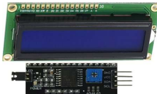
Рис. 17. Дисплей (жидкокристаллический индикатор — ЖКИ 16×2)
