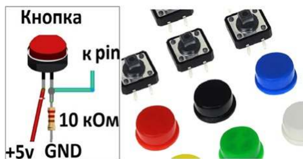
Рис. 1. Схема подключения тактовой кнопки к микроконтроллерной плате
