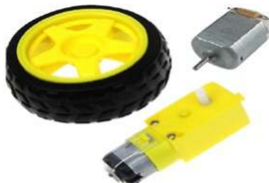
Рис. 18. Двигатели с редуктором
