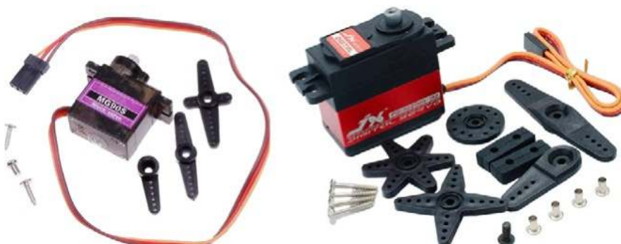
Рис. 19. Серводвигатели MG90S и PDI-6221MG-180
