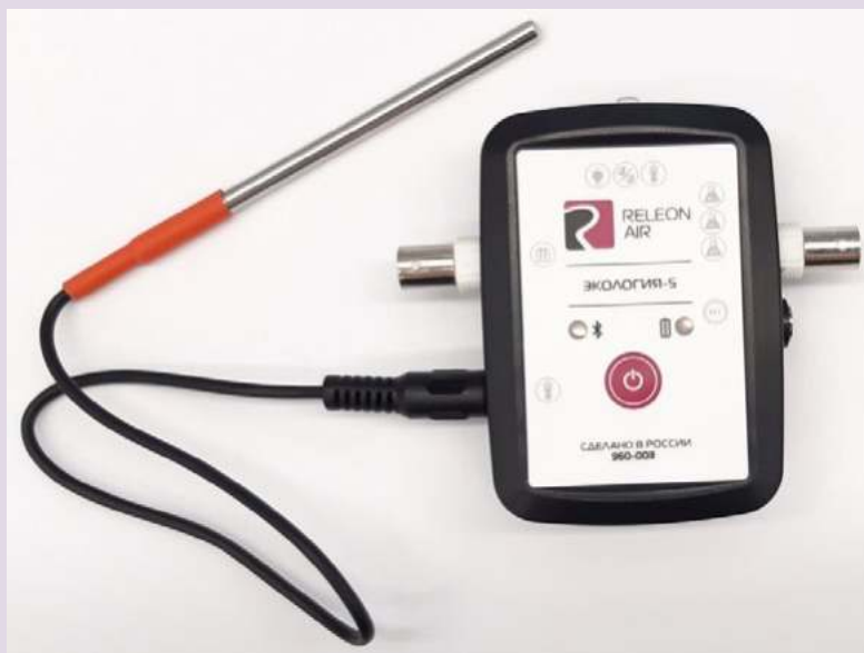
Рис. 6. Датчик температуры растворов
